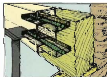
Posare TRS, e portate al livello, poi posizionare il pernio
