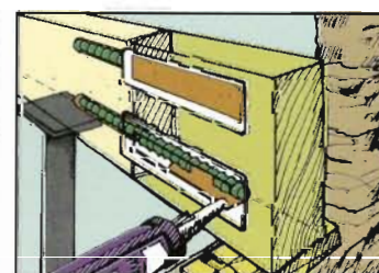
Stuccare e tamponare la fresatura e iniettare Timberset
