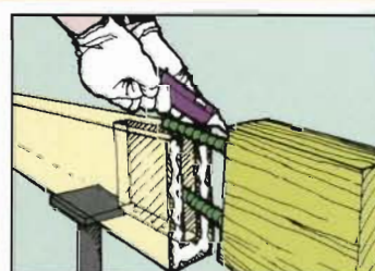
Applicare pasta PB alle due testate
